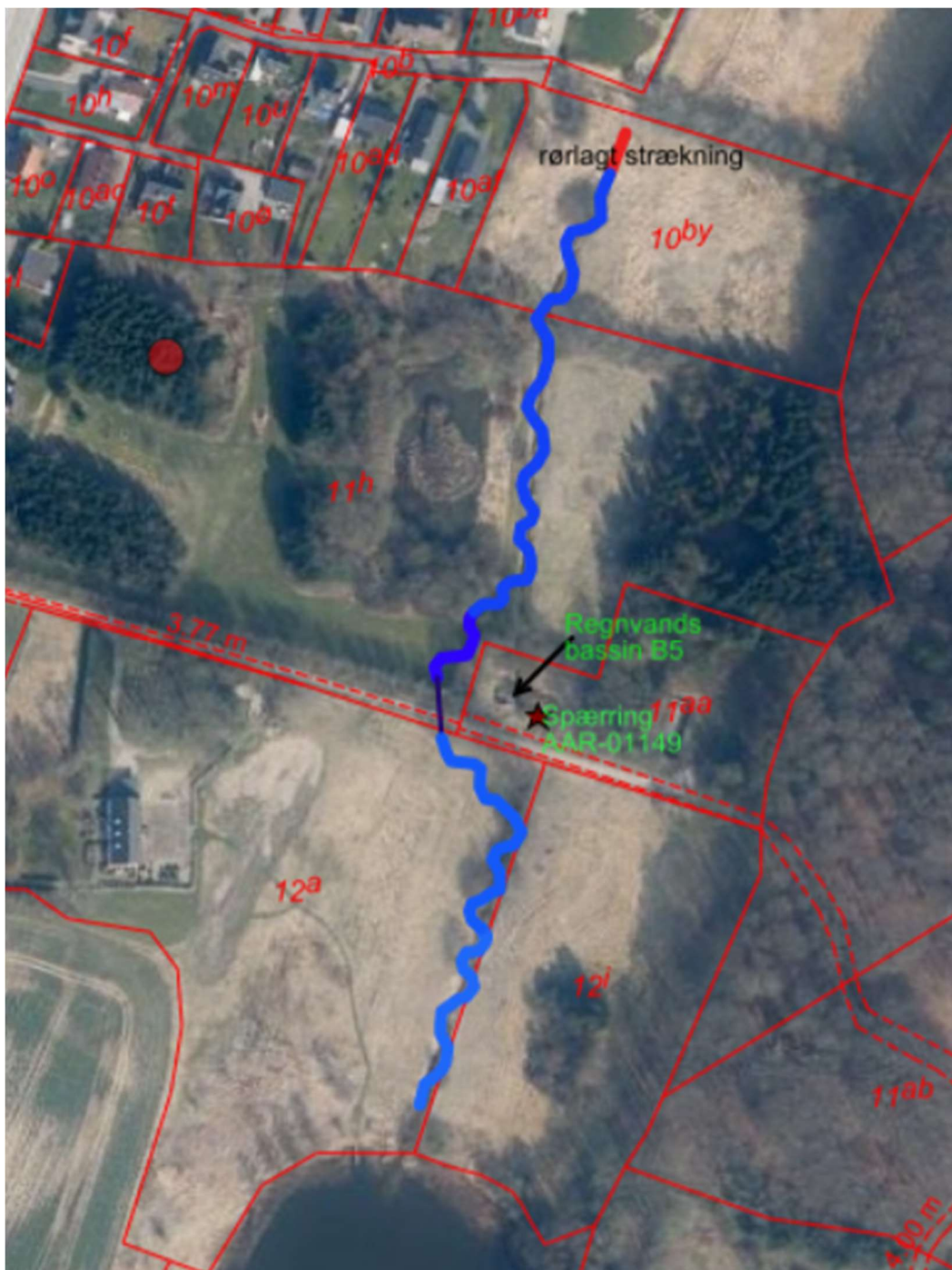
Figur 1: Omtrentlig forløb af vandløbet indenfor projektområdet. Øverst i projektområdet er der en rørlagt strækning der delvist frilægges
